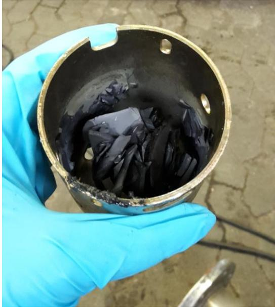
Abbildung 5-24: Stator des Motors der Motorlüftung Modell 2 (VW) mit beschädigten Magneten
