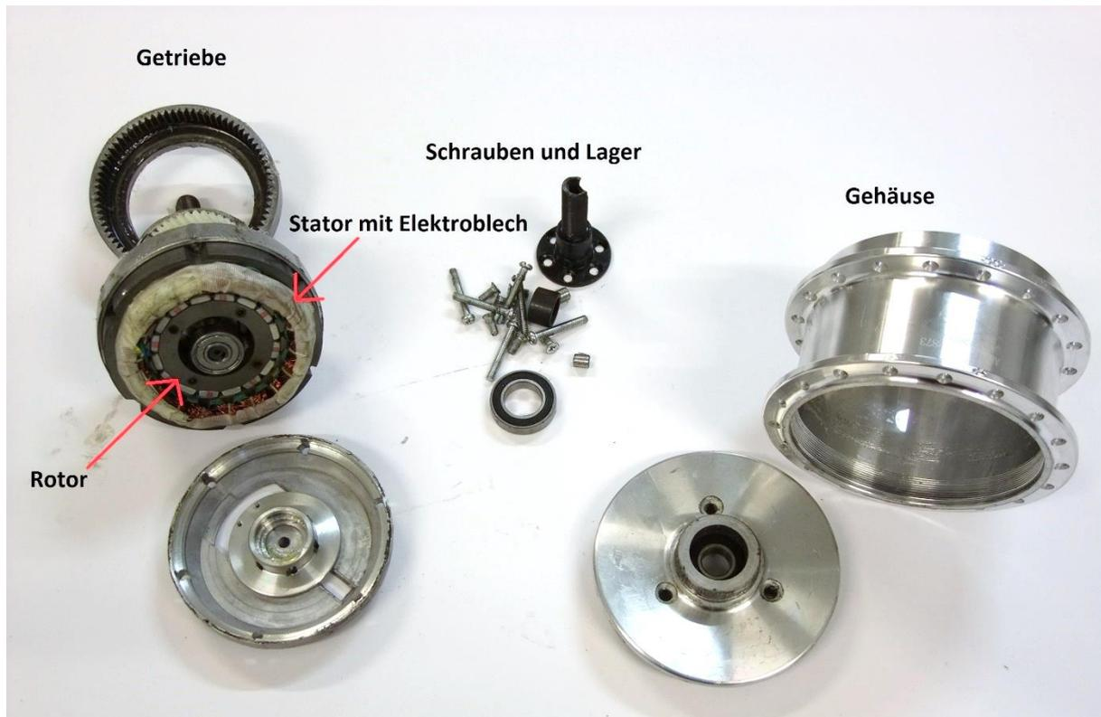
Abbildung 5-4: Separierte Bauteile eines Nabenantriebes
