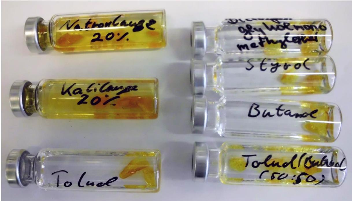
Abbildung 5-15: Proben nach dem Lösemittelversuch bei 60 °C
