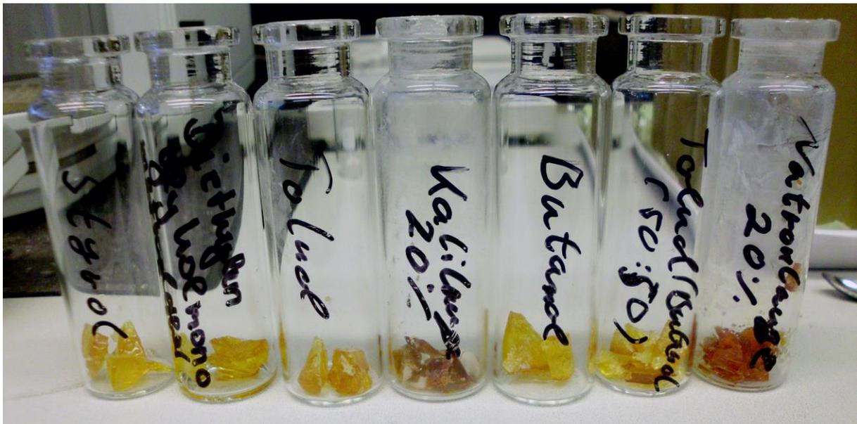
Abbildung 5-16: Getrocknete Tränklackproben nach dem Lösemittelversuch bei 60 °C
