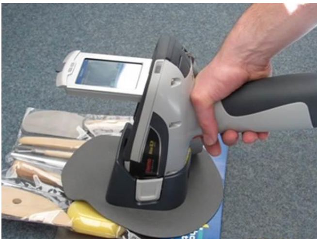
Abbildung 1: Röntgenfluoreszenzanalysator (RFA) im Handbetrieb (Quelle: RPT)
