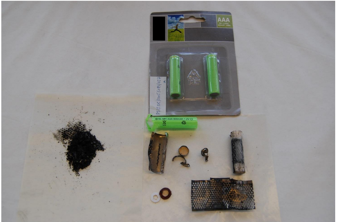
Abbildung 21: In Einzelteile zerlegter Akku vor dem Aufschluss (Quelle: LUBW)
