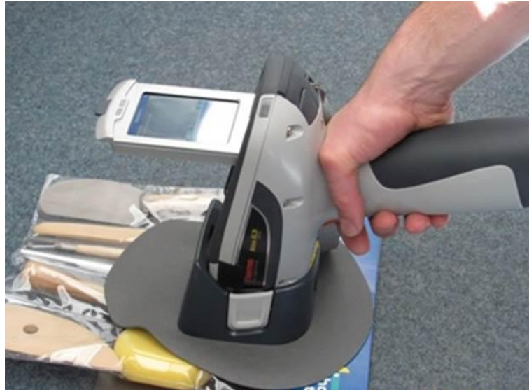
Abbildung 2: Röntgen-Fluoreszenz-Analysator (RFA) im Handbetrieb (Quelle: Regierungspräsidium Tübingen)
