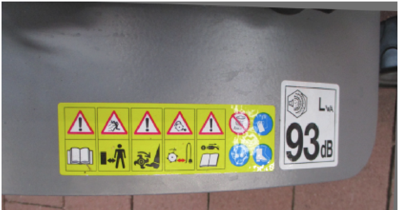
ABBILDUNG 2: BEISPIEL DES ANGEgebenEN GARANTIERTEN SCHALLEISTUNGSPEGELS EINER BENZIN-MOTORHACKE (QUELLE: RPT)
