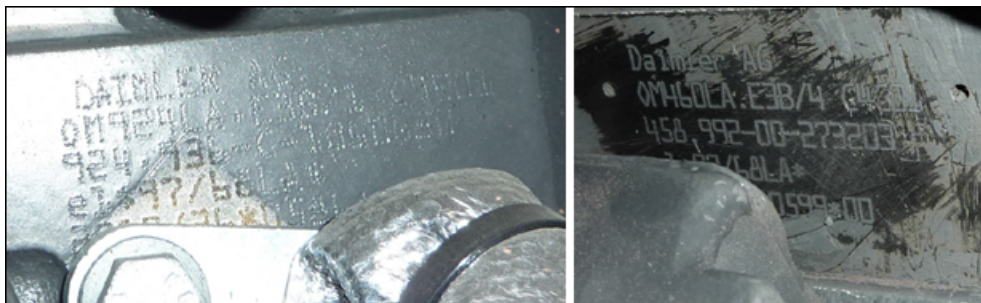
ABBILDUNG 5: SCHWER LESBARE UND TEILWEISE VERDECKTE KENNZEICHNUNGEN (QUELLE: RPT)
