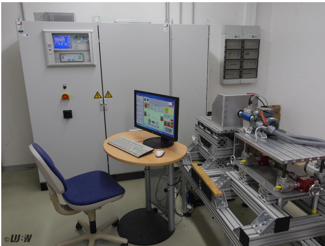
ABBILDUNG 1: AUFBAU DES MOTORENPRÜFSTANDES DER LUBW (QUELLE: LUBW)
