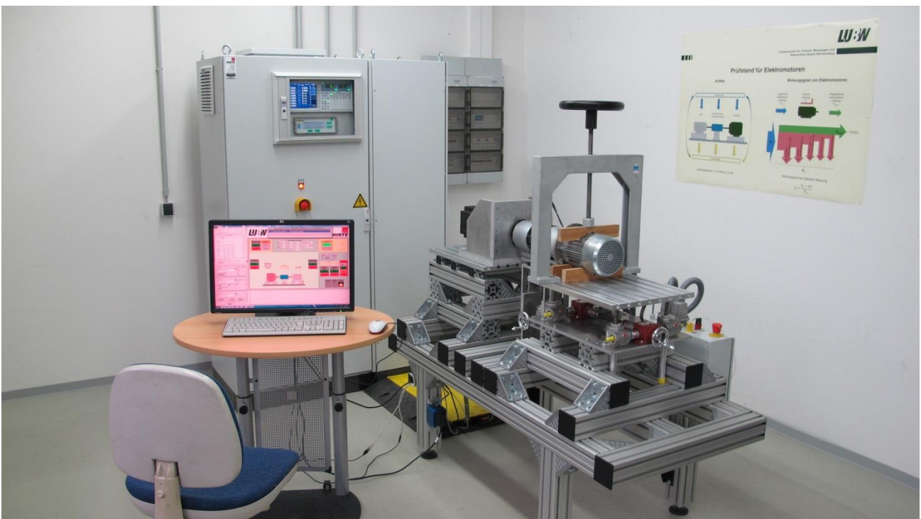
Abbildung 1: Aufbau des Motorenprüfstandes der LUBW (Quelle: LUBW)
