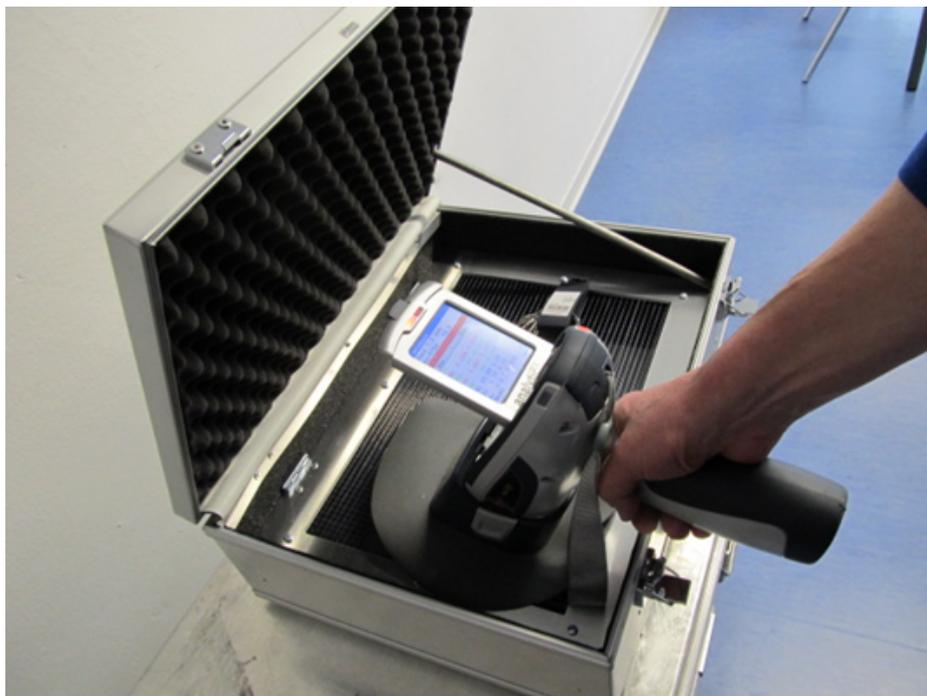
ABBILDUNG 25: RFA-MESSUNG EINER SCHMUCKWARE (QUELLE: RPT)
