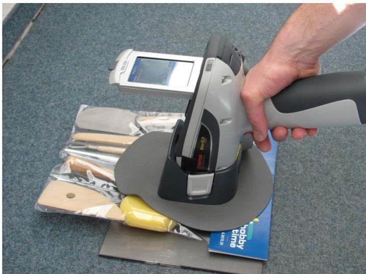
ABBILDUNG 1: MOBILES RÖNTGENFLUORESCENZ-ANALYSEGERÄT (RFA) IM EINSATZ (QUELLE: RPT)
