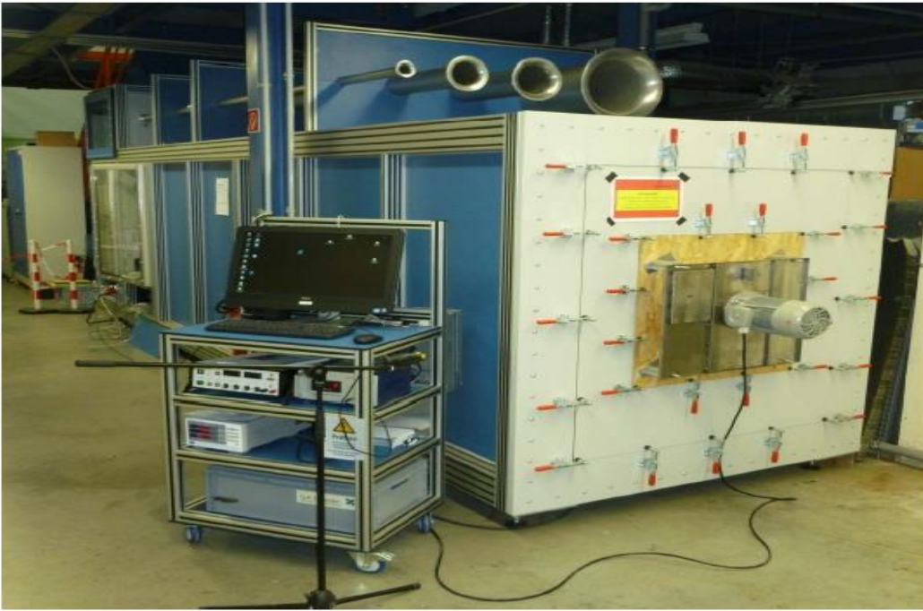
ABBILDUNG 3: PRÜFSTAND MIT INSTALLIERTEM PRÜFLING (QUELLE: PRÜFBERICHT ILK)
