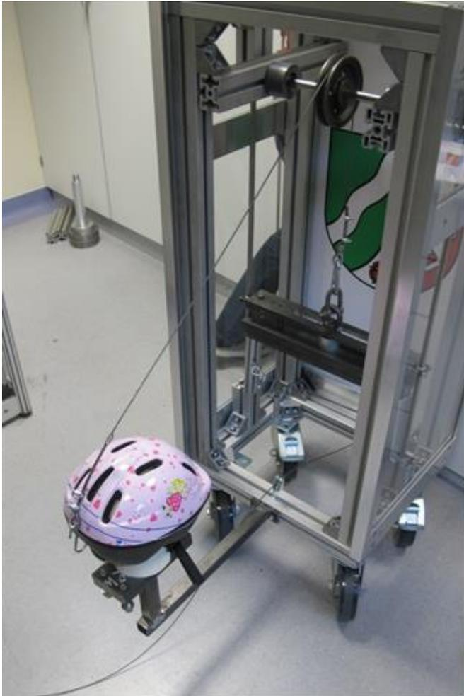
Abbildung 4: Prüfstand zur Prüfung der Wirksamkeit der Trageeinrichtung (Quelle: LUBW)
