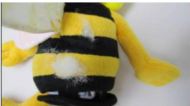
Abbildung 2: Prüfobjekt mit gerissenen Nähten und verschluckbarem Füllmaterial nach dem Zugtest (Quelle LUBW)
