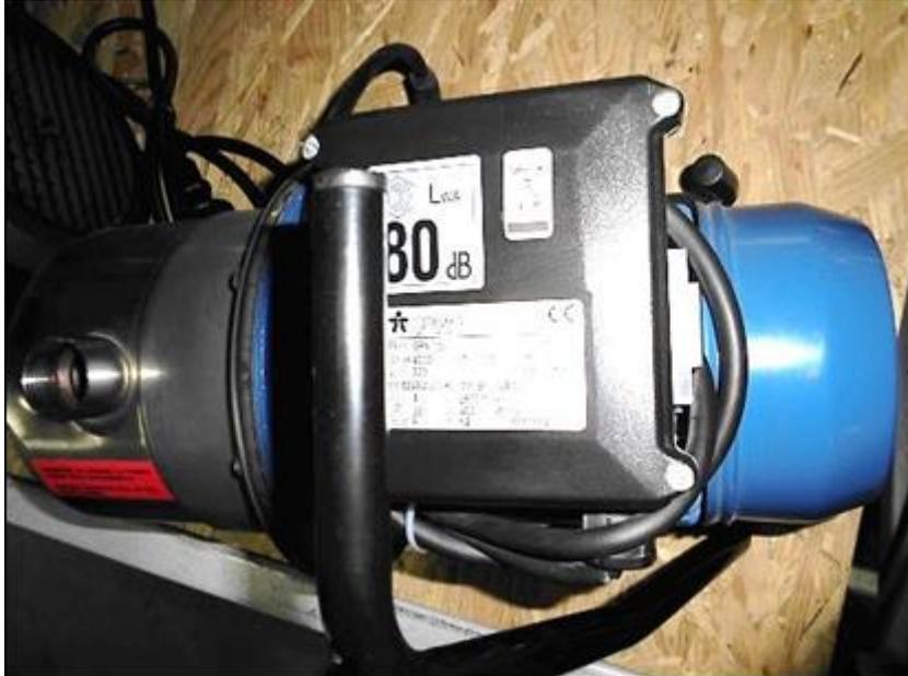
Abbildung 6: Angabe des Schalleistungspegels (Quelle: RPT)
