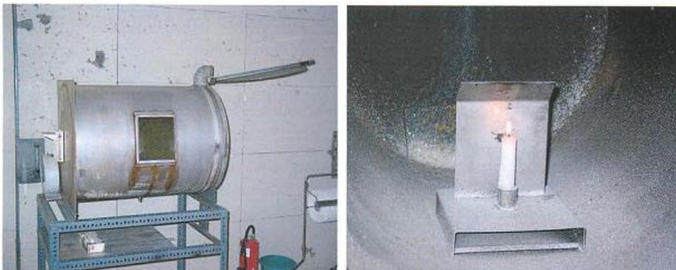
Abbildung 3: Foto des Prüffasses und der im Fass brennenden Kerze als Zündflamme (Bildquelle: Bundesanstalt für Materialforschung und -prüfung (BAM), Berlin)
