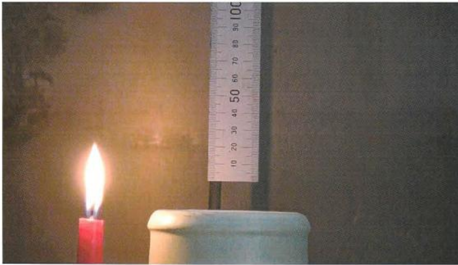
Abbildung 4: Foto des Versuchsaufbaues für den Schaumtest (Bildquelle: Bundesanstalt für Materialforschung und -prüfung (BAM), Berlin)
