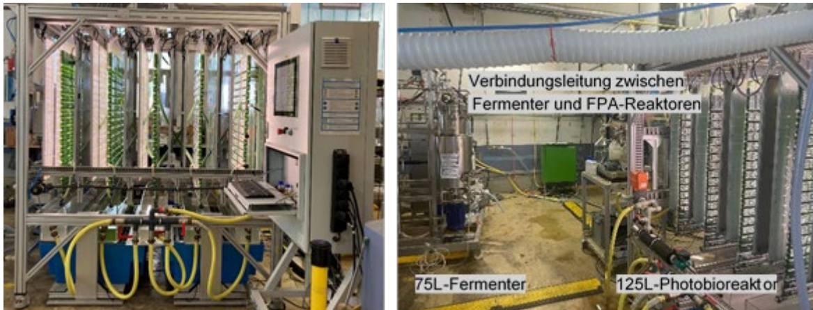
Abbildung 28: Installation des in TP5.1 aufgebauten Photobioreaktoranlage bestehend aus fünf miteinander gekoppelten 25L FPA-Reaktoren.
