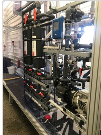
Abbildung 12: a) Darstellung der chemischen Absorption durch die Membranen, b) AmmoRe-Pilotanlage zur Stickstoffrückgewinnung
