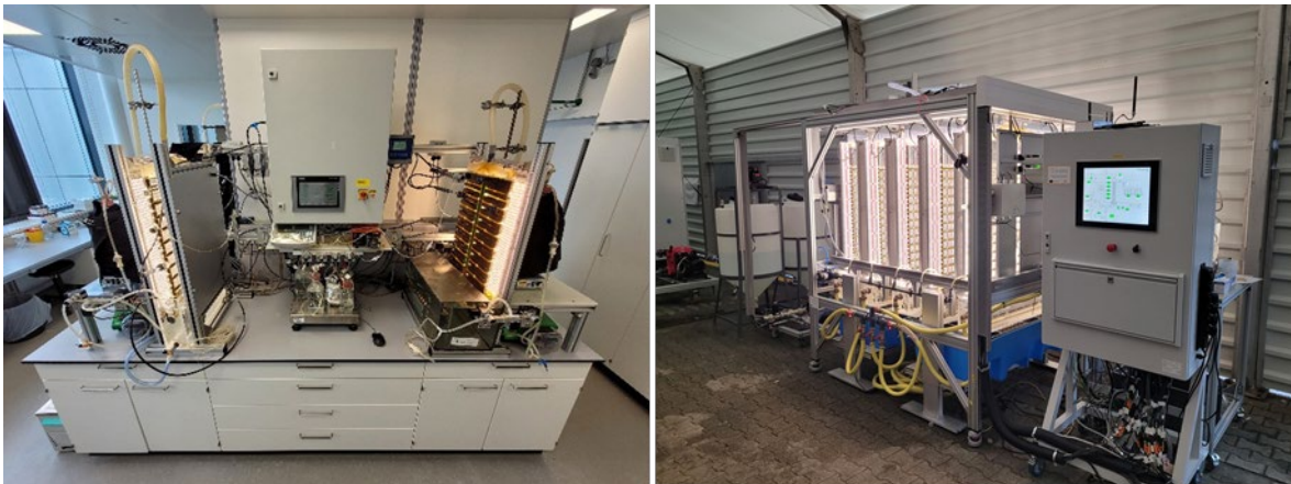
Abbildung 25: Abbildung der in diesem Projekt verwendeten Photobioreaktorsysteme im 6-Liter-Maßstab in der Laborumgebung (links) sowie im 125-Liter-Maßstab auf der Kläranlage Erbach (Rechts).
