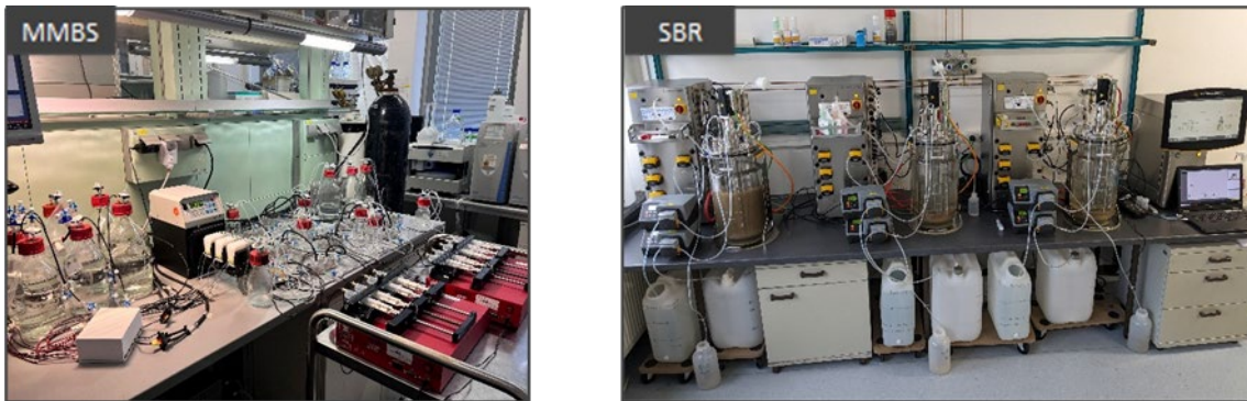
Abbildung 4: Aufbau und Prozessbedingungen der MMBS- und SBR-Versuche zur Untersuchung der Bio-P-Prozesse im Rahmen von RoKka (Bildquelle: Universität Kassel; TUHH).
