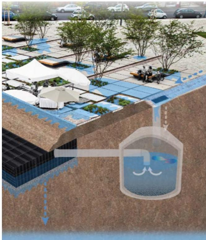
Abb.: Integriertes Regenwasserkonzept – Quelle: Henning Larsen
