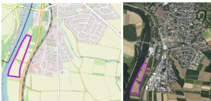
Abbildung 24: Beispielfläche mit einer Größe von 7 ha zur Bereitstellung von 23 GWh/Jahr Wärme durch eine Fluss-Wärmepumpe.
