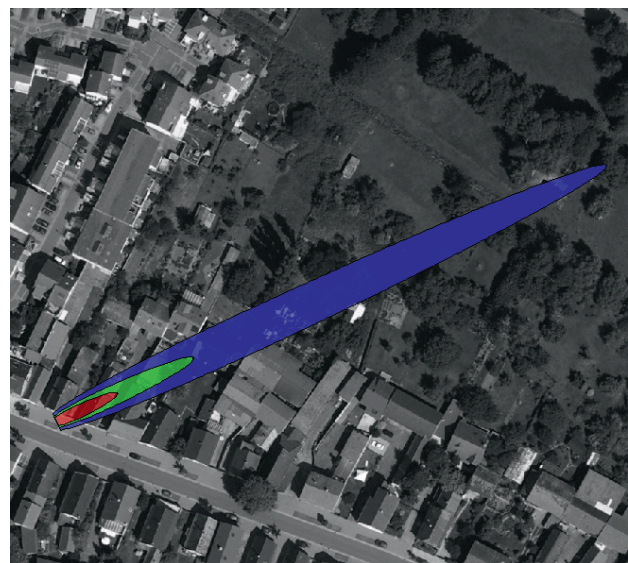
Abbildung 1.5-1: Mit der Grundwasserdatenbank berechnetes Temperaturfeld, Darstellung im integrierten Kartografiesystem (rot: Temperaturabsenkung um 3 Grad Celsius, grün: 2 Grad, blau 1 Grad)
