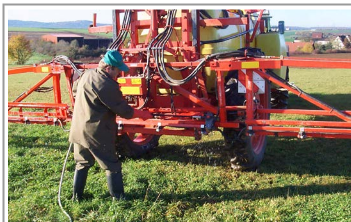
Bild 4: Sachgerechte Reinigung der Feldspritze
