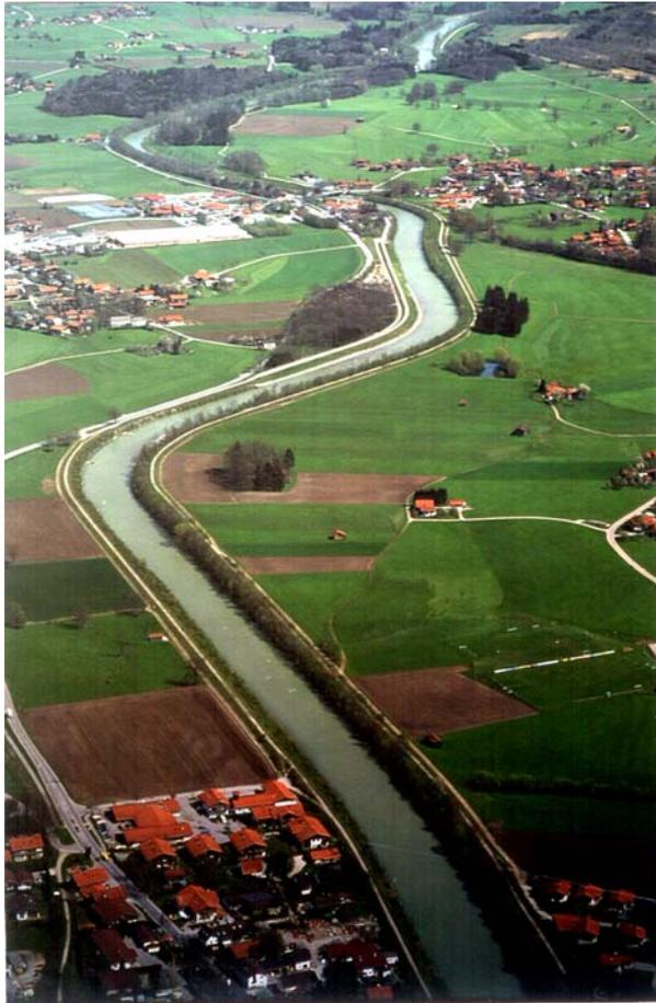
**Abbildung 2.3.6:** Die Linienführung eines Fließgewässers ist einer der wichtigsten Hinweise auf den Grad der anthropogenen Veränderungen. Das Bild zeigt, dass die Linienführung der Tiroler Ache, in diesem Abschnitt deutlich anthropogen beeinflusst ist.
