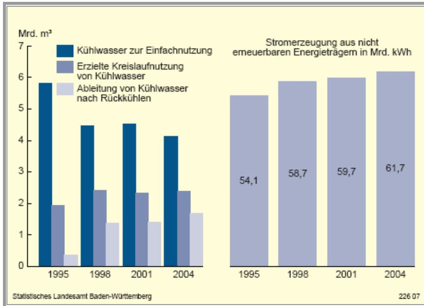
Abbildung 6: Kühlwasserbedarf und Bruttostromerzeugung der Kraftwerke für die allgemeine Versorgung in Baden-Württemberg [6]
