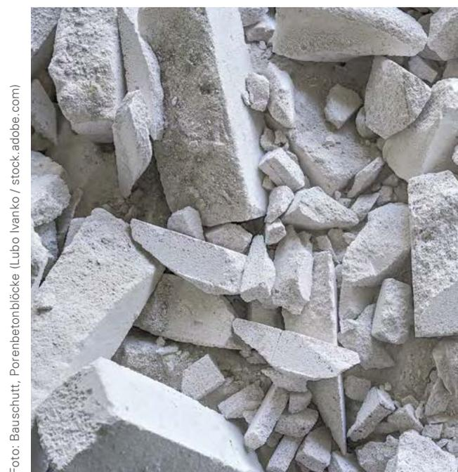
Foto: Bauschutt, Porenbetonblöcke (Lubo Ivanko / stock.adobe.com)
