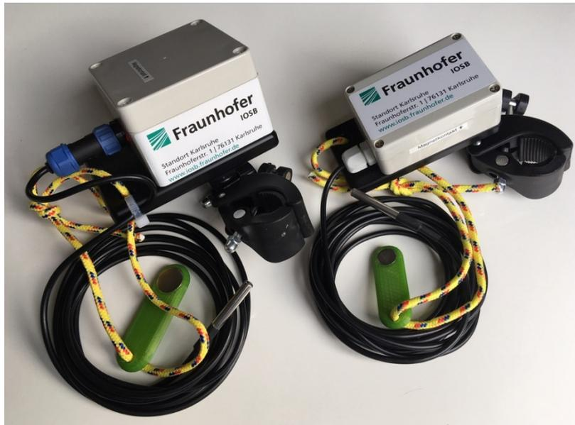
Abbildung 1 - Sensoren mit Klemmhalterung
