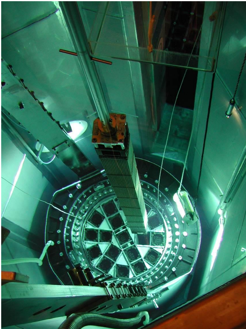
Abbildung 10: Beladung eines CASTOR-Behälters mit einem Brennelement (Beladung unter Wasser im Lagerbecken) (Quelle EnKK)
