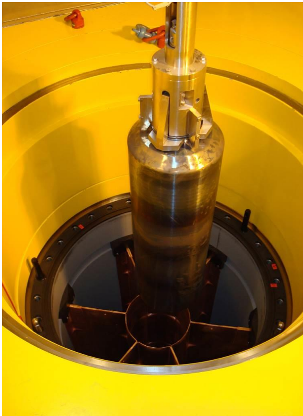
Abbildung 3: CASTOR-Beladung mit einer Glaskokille während einer „kalten“ Handhabung (Quelle KTE)
