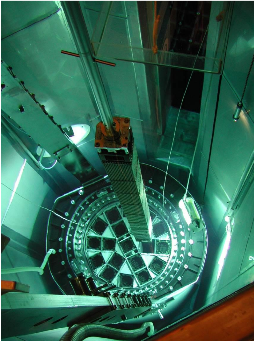
Abbildung 10: Beladung eines Castor-Behälters mit einem Brennelement (Beladung unter Wasser im Lagerbecken)
