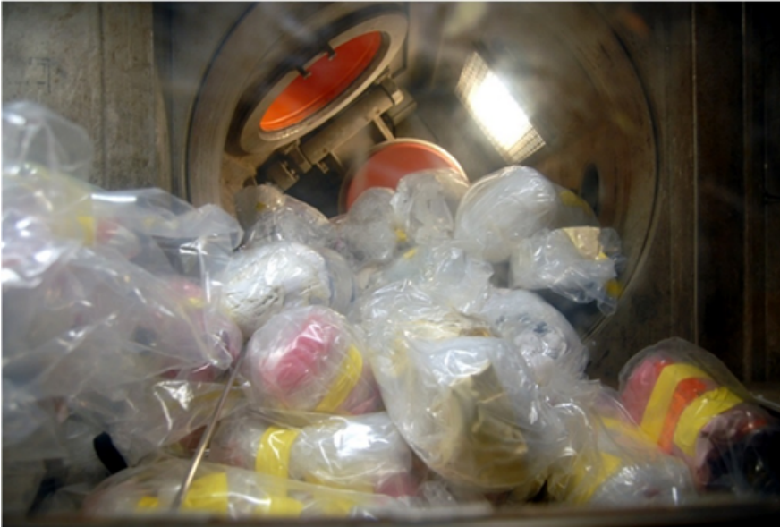
Abbildung 7: Beschickungsbox der Verbrennungsanlage bei den Entsorgungsbetrieben
