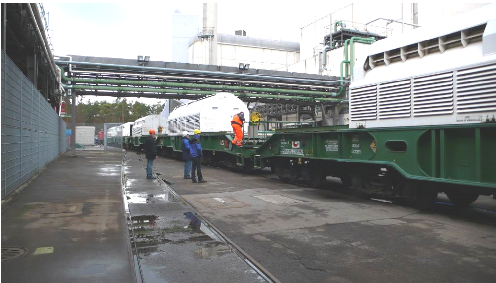
Abbildung 3: Im Februar 2011 auf dem Gelände der WAK zum Abtransport bereitstehende, mit Glaskokillen beladene Castor-Behälter
