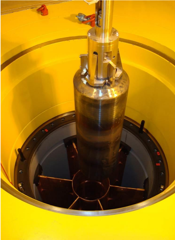
Abbildung 3: CASTOR-Beladung mit einer Glaskokille („kalte“ Handhabung)
