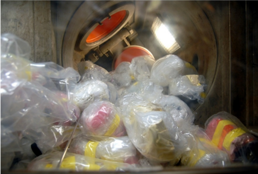
Abbildung 7: Beschickungsbox der Verbrennungsanlage bei den Entsorgungsbetrieben
