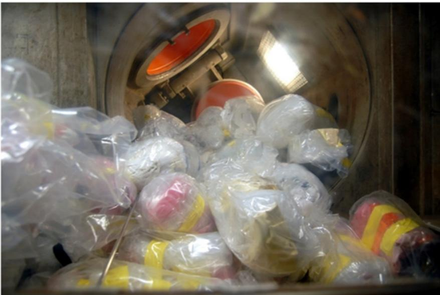
*Abbildung 7: Beschickungsbox der Verbrennungsanlage bei den Entsorgungsbetrieben*
