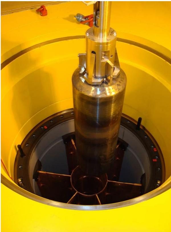
Abbildung 2: Castor-Beladung mit einer Glaskokille („kalte“ Handhabung)
