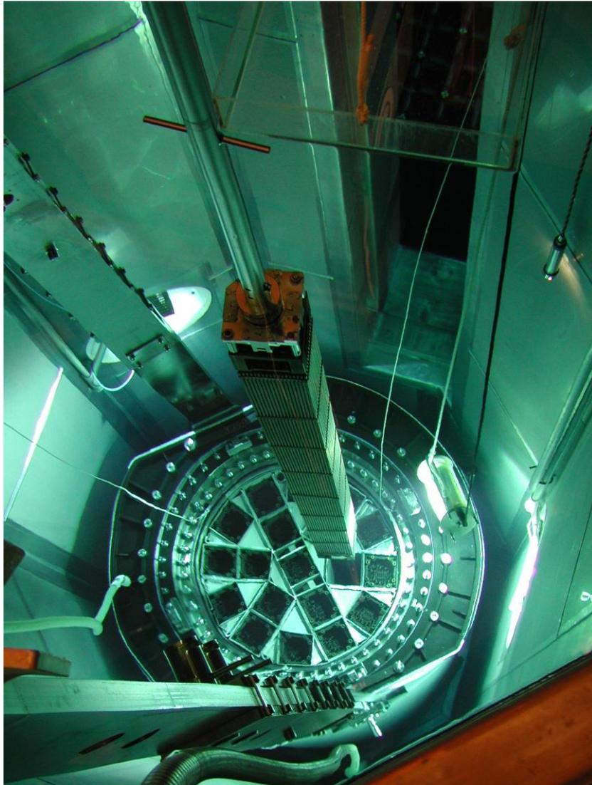
**Beladung eines CASTOR-Behälters mit einem Brennelement
