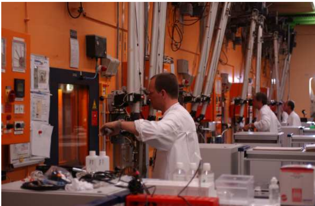
Abbildung 3-4: Bestimmung des Nuklidvektors an hochaktiven Spaltprodukten
