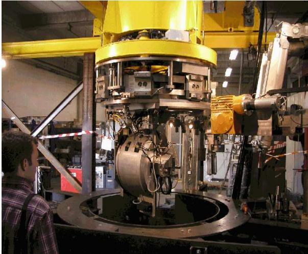
**Abbildung 4-5: Zerlegemaschine für den Reaktortank bei der Erprobung**
