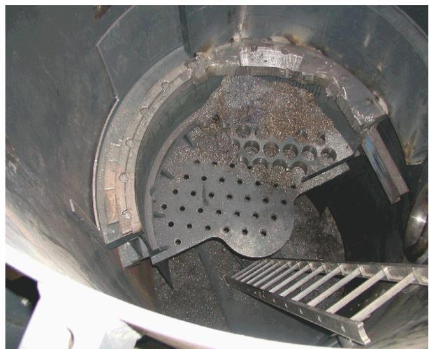
**Abbildung 4-3 : Blick ins Modell des Reaktortanks bei Erprobung der Zerlegemaschine**
