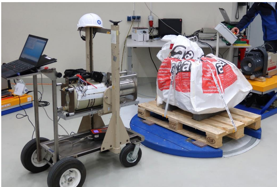
Abbildung 1: Kontrollmessung des Sachverständigen mittels in-situ-Gammaspektrometriemessgerät (Quelle: EnKK)
