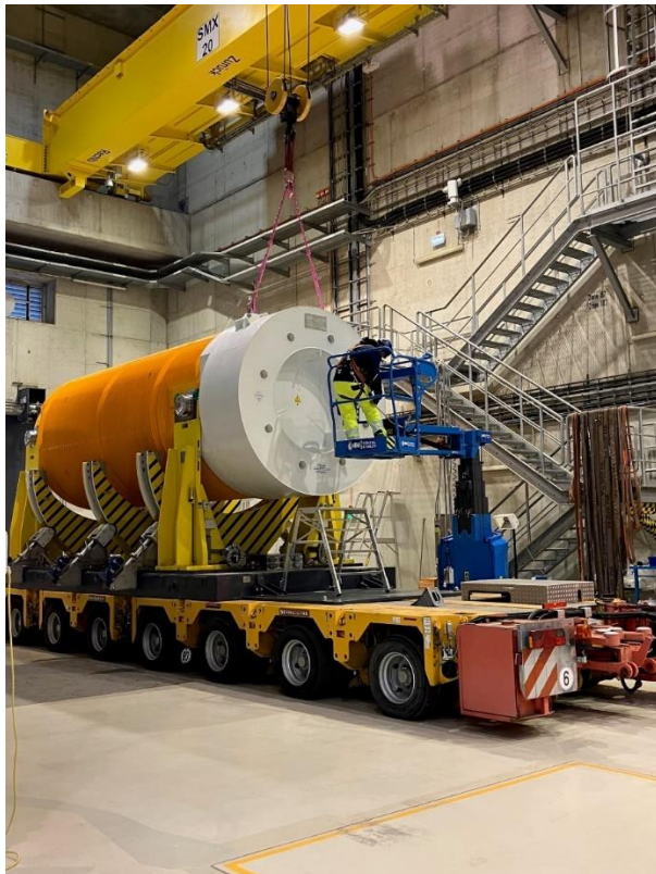
Abbildung 1: Transport- und Lagerbehälter aus Frankreich im Brennelemente-Zwischenlager Philippsburg (Quelle: UM)
