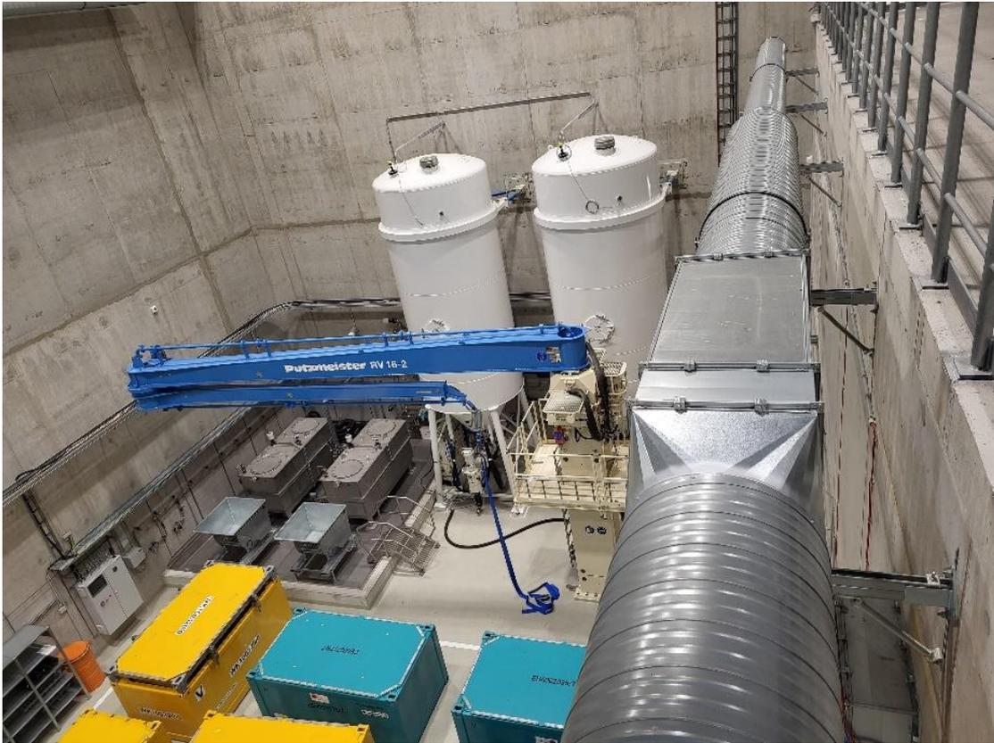
Abbildung 6: Vergießanlage in L567 (Quelle: KTE)
