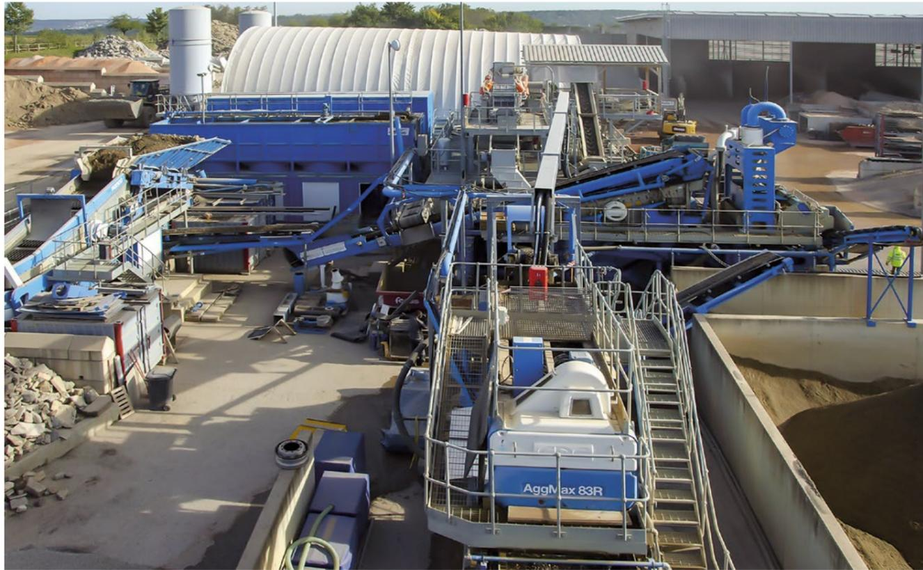
Anlage zur Aufbereitung von Bodenaushubmassen mittels Schwertwäsche und Nassklassierung © feess
