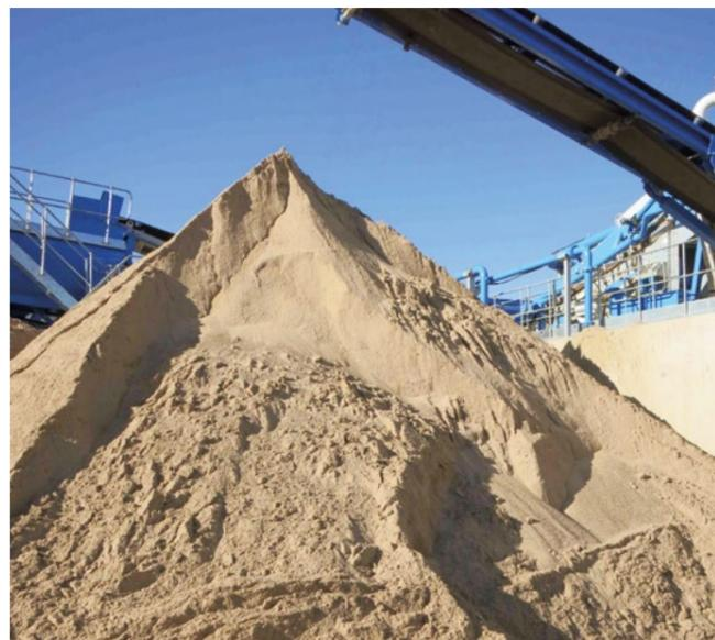
Kiese und Sande aus der Aufbereitung von Bodenaushubmassen © feess
