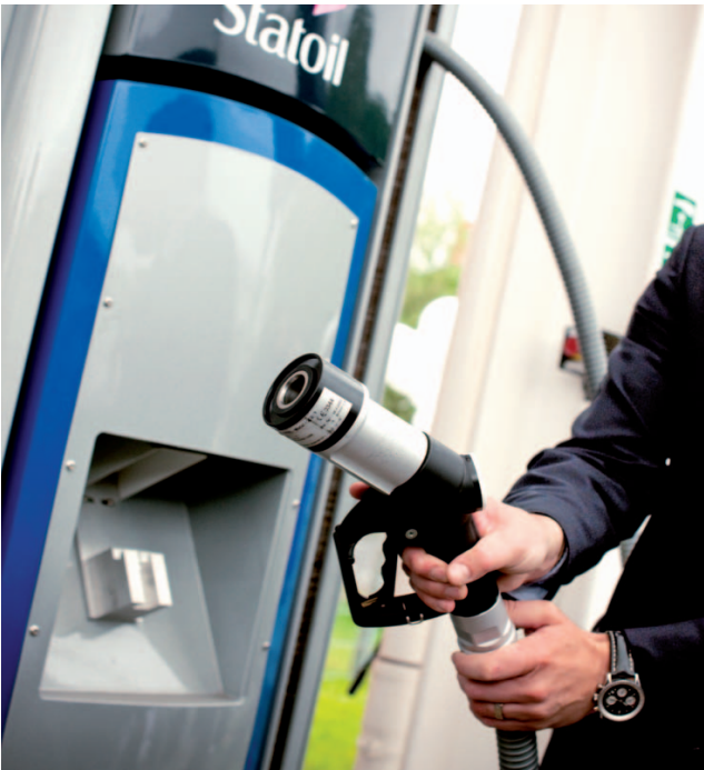
Abbildung 25: 700-bar-Zapfsäule an der CEP Tankstelle Berlin Holzmarkstraße (Quelle: CEP)
