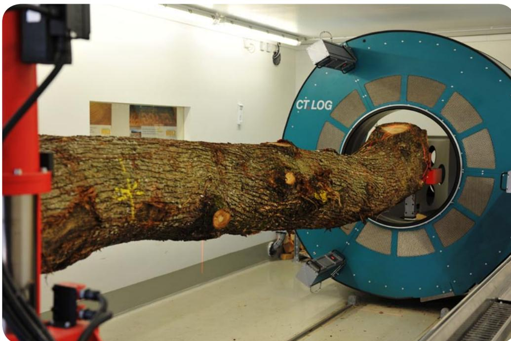
*Computertomograph zur Qualitätsbestimmung von Rundholz (Bild: © FVA BW)*
