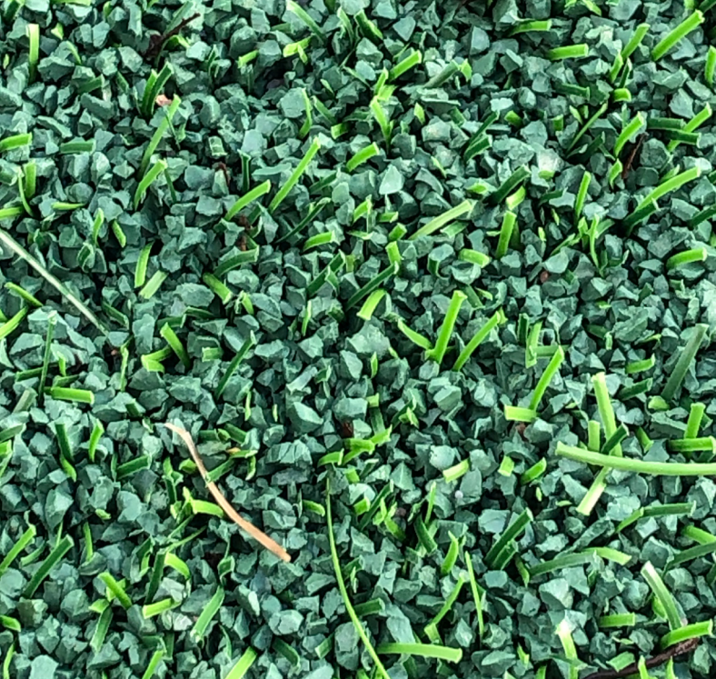
Kunststoffgranulat aus EPDM (Ethylen-Propylen-Dien-Kautschuke).
