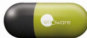
Unscheinbarer als ein Molch: Der Prototyp des schwimmenden Sensors hat gerade einmal zwei Zentimeter Durchmesser.
