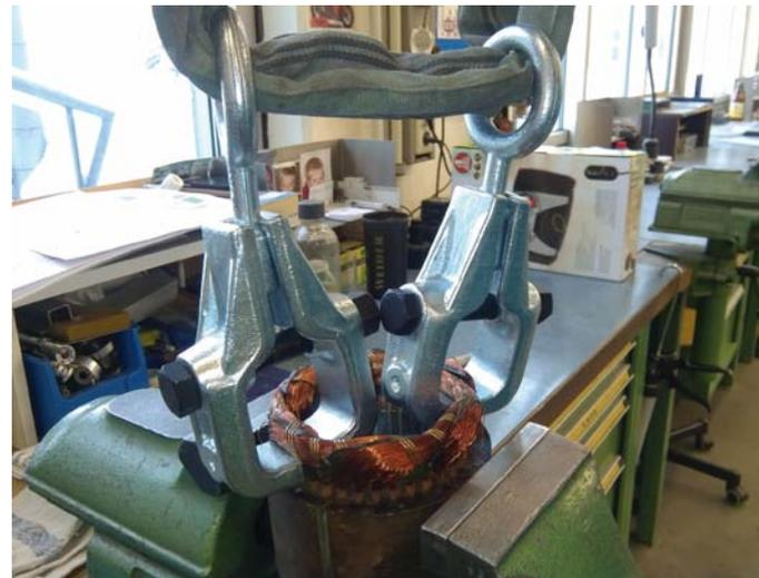
Versuchsaufbau: Karosserie-Zugklemmen werden an den Kupfersträngen befestigt.
