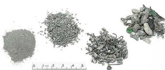
Sortiertes Schlackenmaterial aus der Müllverbrennungsanlage
