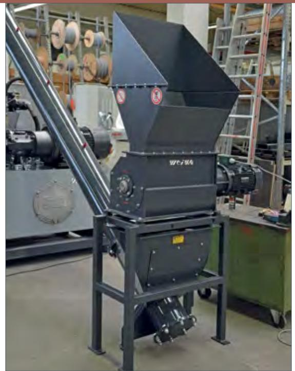
Abb. 3: Hammermühle zur Zerkleinerung
