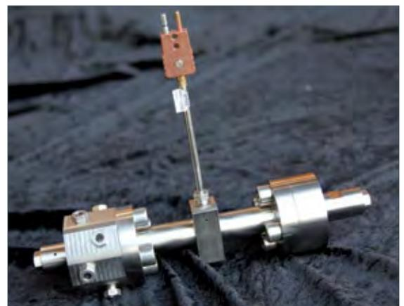
Präzisionsarbeit: Düse zur Messung des Wasserstoff-Durchflusses, hier ohne die Sensorik
