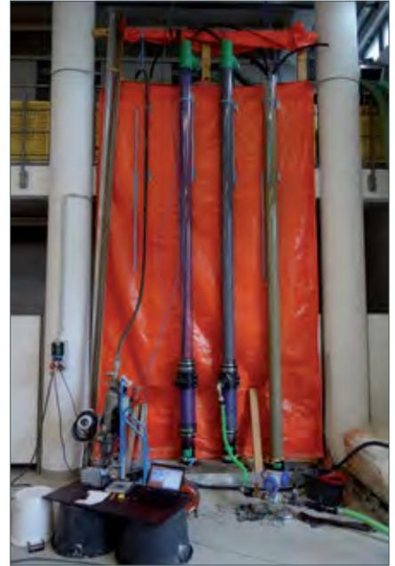
der Einfluss der Grundwasserströme auf verschiedene eigens entwickelte Verfüllmaterialien abbilden.
