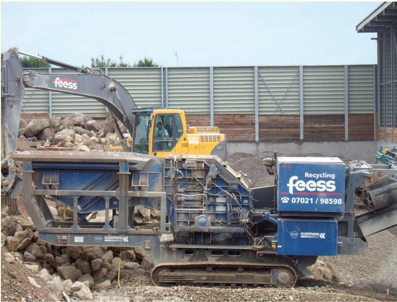
Für den Einsatz im R-Beton muss die RC-Gesteinskörnung  $> 2$  mm sein. Deshalb muss nach dieser Zerkleinerung zwingend eine Abtrennung der Feinfraktion bzw. des Brechsandes erfolgen.
