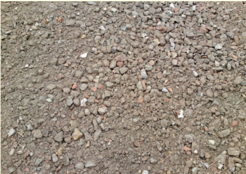
Abb. 3: GÜTEÜBERWACHTE FROSTSCHUTZSCHICHT FSS AUS RC-MATERIAL (EINGEBAUT)
