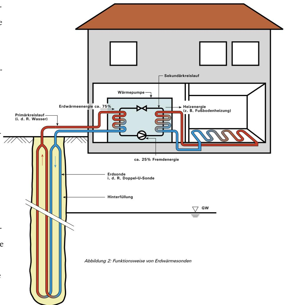
Abbildung 2: Funktionsweise von Erdwärmesonden
