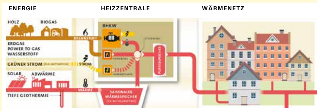
Schematischer Aufbau eines Nahwärmenetzes
