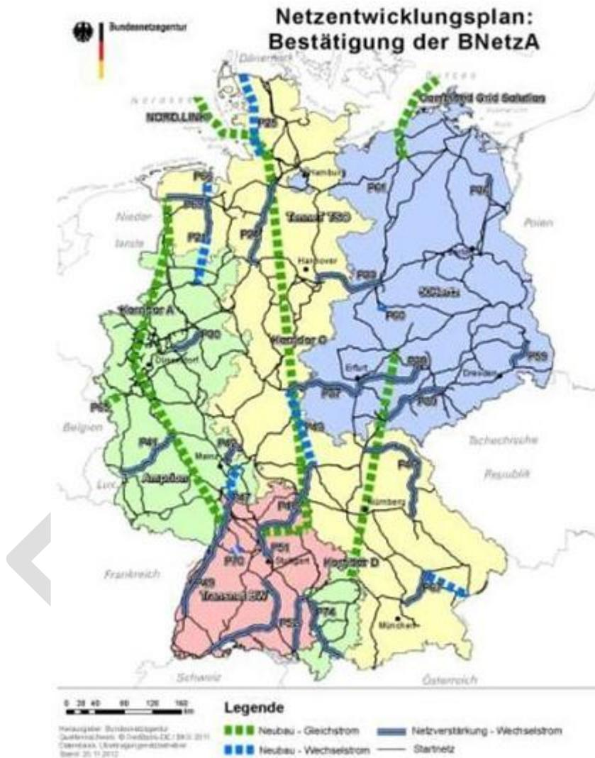
Bild 19: Leitszenario zum Ausbaus des Übertragungsnetzes (aus: Netzentwicklungsplan Strom 2012)
