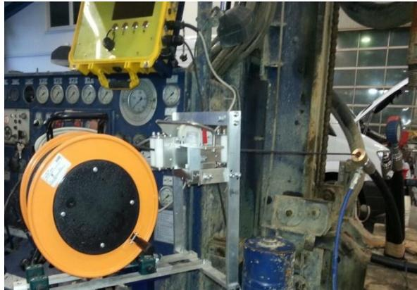
Der *CemTrakker* ist ein präzises Messgerät zur Detektion ferromagnetischer und elektrisch leitfähiger Materialien. Es kann zwischen elektrisch leitfähigen und magnetisch leitfähigen Stoffen unterscheiden. Damit ist es ideal für den Einsatz in der Materialprüfung und bei der Qualitätskontrolle bei Bohrlochverfüllungen einsetzbar. Die Messgeräte müssen am Bohrgerät fest angebaut sein.
