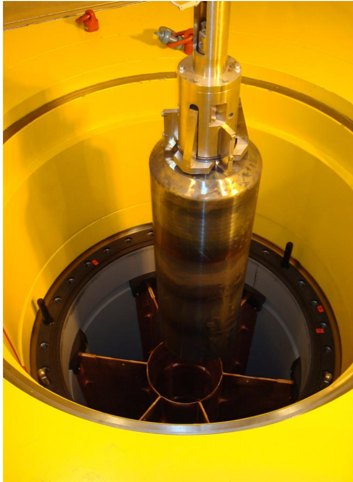
Castor-Beladung mit einer Glaskokille („kalte“ Handhabung)
