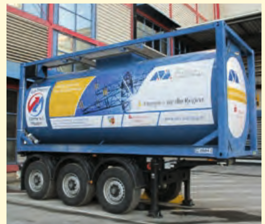
ABB. 43: LATENTWÄRMESPEICHER FÜR DEN MOBILLEN WÄRMETRANSPORT (AVA AUGSBURG 2015)
