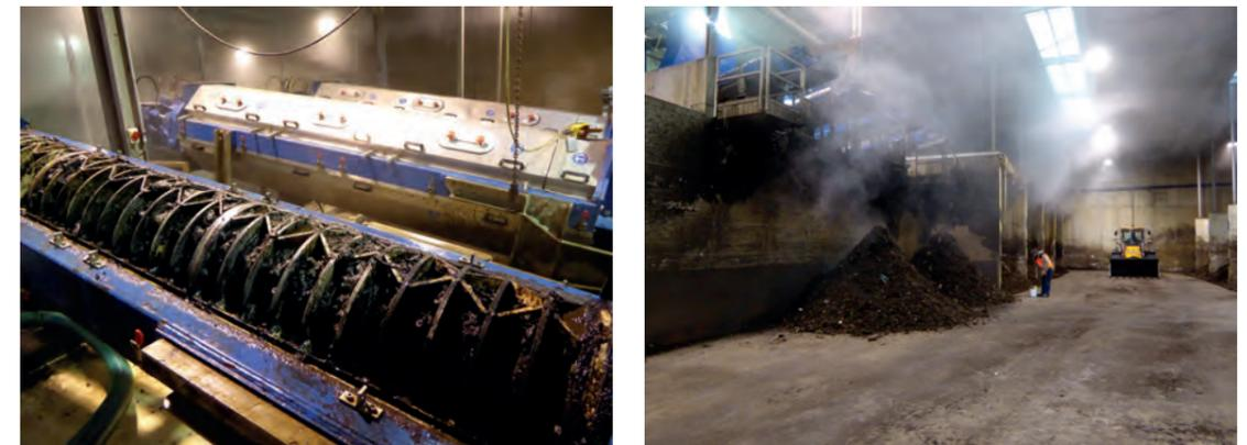
Abb. 19: Pressschnecken zur Entwässerung von Bioabfallgärrest (Foto: W-I 2015)
