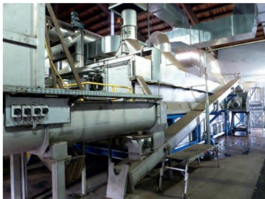
Abb. 21: Bandrockner für Gärreste der Bioabfallvergärungsanlage Leonberg
